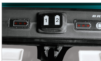
LED indicatori carica batterie
